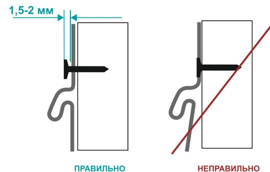
Не крепите сайдинг слишком плотно к обрешетке! Не зажимайте саморезы до конца! Оставьте зазор приблизительно 1,5-2 мм между шляпкой самореза и виниловой панелью. Это необходимо для свободного расширения-сжатия и предотвращения коробления обшивки.
