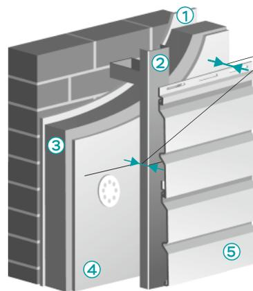
**ОБЯЗАТЕЛЬНЫЙ ВЕНТИЛИРУЕМЫЙ ЗАЗОР 30-50мм**
