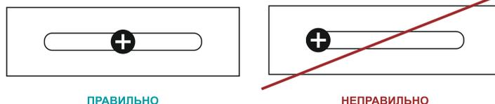
Саморезы надо вкручивать в середину продолговатого крепежного отверстия, а не с краю - это может впоследствии привести к неправильному линейному расширению панели и аксессуаров сайдинга. Вкручивать саморезы необходимо с шагом 30-40 см. После вкручивания всех саморезов панели должны свободно перемещаться в ту и другую сторону по горизонтальной в пределах ширин крепежных отверстий.
